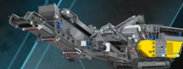
RM 100XE HYBRID* Mobilní hybridní drtič s volitelným připojením k elektrické síti
